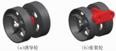
图 11 诱导轮与张紧轮总成模型
