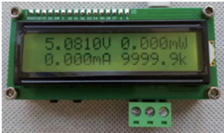
图 7 电流检测模块实物图
