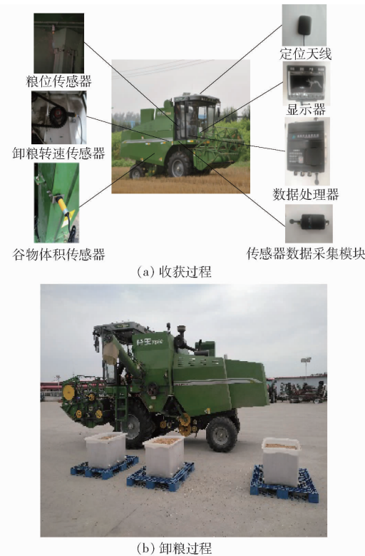
图9 误差动态自校准田间试验
