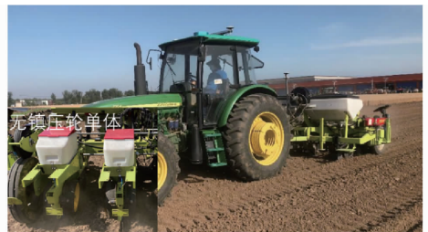
图 9 田间试验播种机及无镇压轮单体
