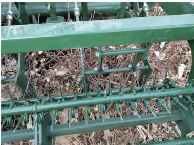
图7 对行铲切装置处棉秆拥堵情况
