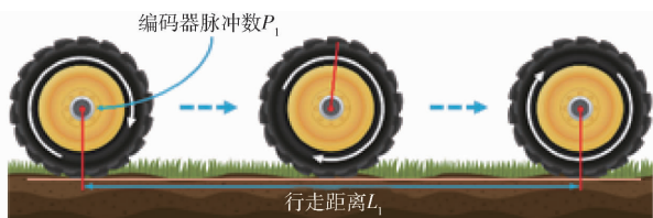
图 7 驱动轮回转半径标定方法示意图
