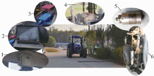
图9 电液悬挂系统动压反馈校正试验平台
