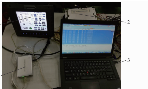
图 11 虚拟终端及数据采集系统
