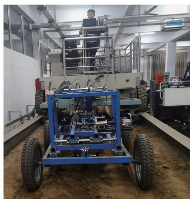
图 3 土槽试验测试系统
