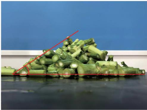
图 1 饲料油菜茎秆颗粒堆积试验
