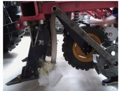
图10 各层肥料分配性能试验
