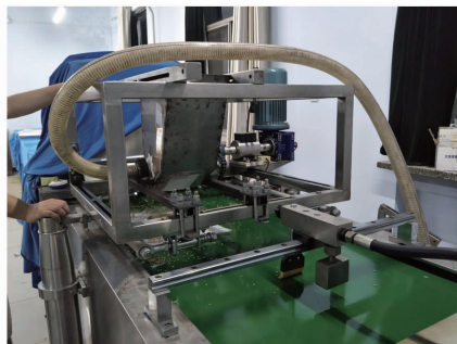
图 4 JPS-12 型计算机视觉排种器试验台
