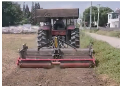
图7 幅宽 2.3 m 双轴旋耕机
