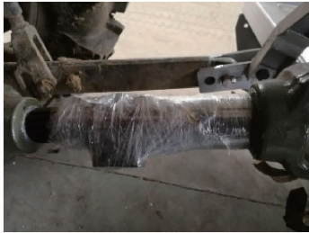
图 10 DH5905 型无线扭矩测试分析系统实际布置情况
