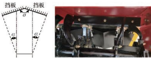
图9 V型土壤导流板结构图与实物图
