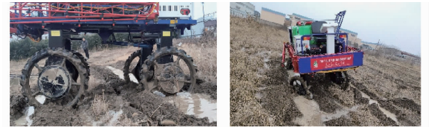
(a) 喷雾机横越深沟 (b) 右侧轮陷入深沟
