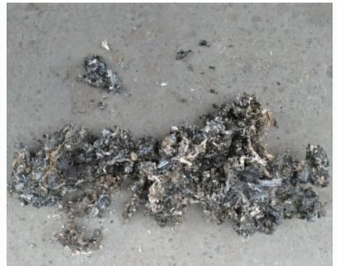
图10 玉米秸秆碎料燃烧后结渣
