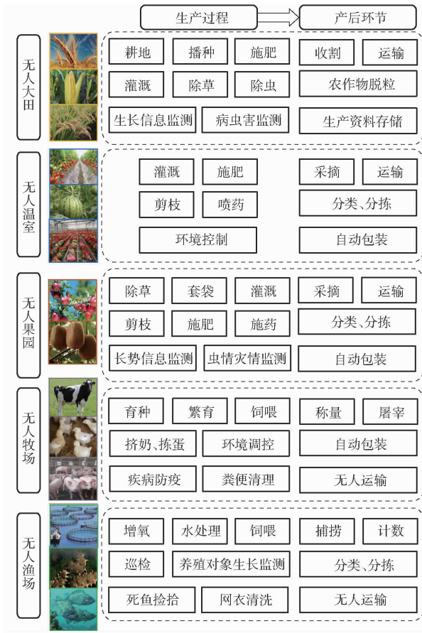
图 4 无人农场五大类型 Fig. 4 Five types of unmanned farm
