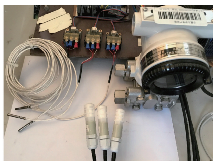
图5 温湿度传感器及压力变送器
