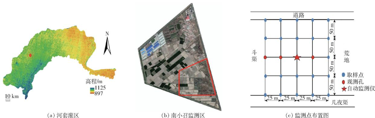
图2 试验区土壤盐监测点布置图
