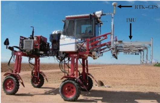
(a) 前臂配备铝槽安装包括惯性测量单元(IMU)和实时运动全球定位系统(RTK-GPS)的近端传感器
