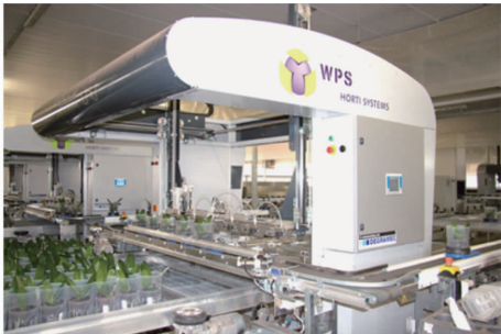
图 5 WPS 公司的传送带式温室植物表型平台
