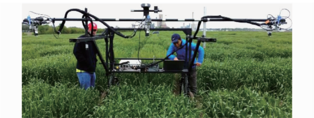
图 9 美国内布拉斯加大学林肯分校的田间高通量表型分析平台 Fig. 9 Platform to mount multi-sensor system for high throughput field phenotyping
