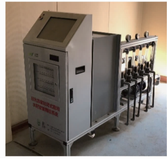
图 2 CAUA-12 型水肥一体化灌溉设备
