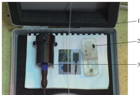
图 3 FluorMonitor 荧光传感器
