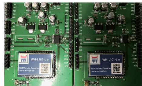
图 2 物联网节点核心板硬件实物图 Fig. 2 IoT node core board's physical map
