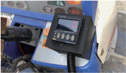
图6 计数继电器安装示意图
