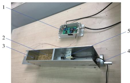
图 3 标定试验台架结构
