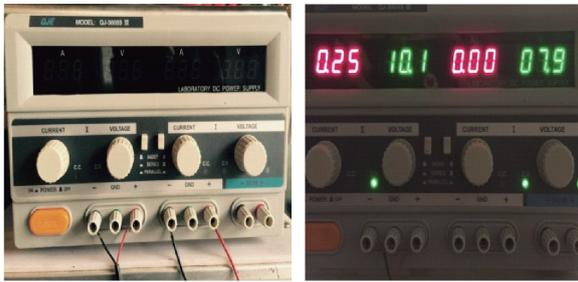
(a) QJ-3005S III型电源 (b) 电源显示界面
