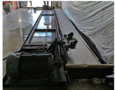
图8 同步开孔插秧装置试验台
