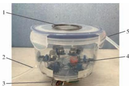
图1 电子鼻检测气室
