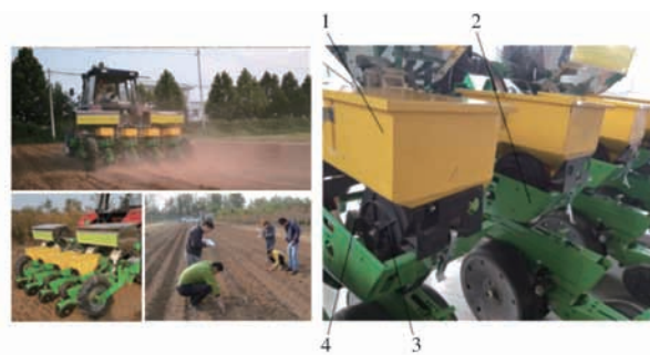
图16 排种器田间试验与检测情况
