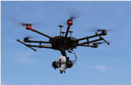
图2 无人机和高光谱遥感图像采集系统
