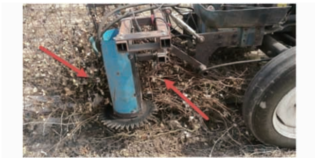
图 14 棉秆堵塞实况图 Fig. 14 Cotton-stalk clogged
