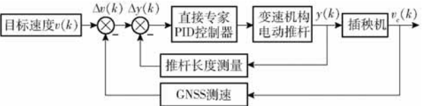
图 5 插秧机速度控制原理图
