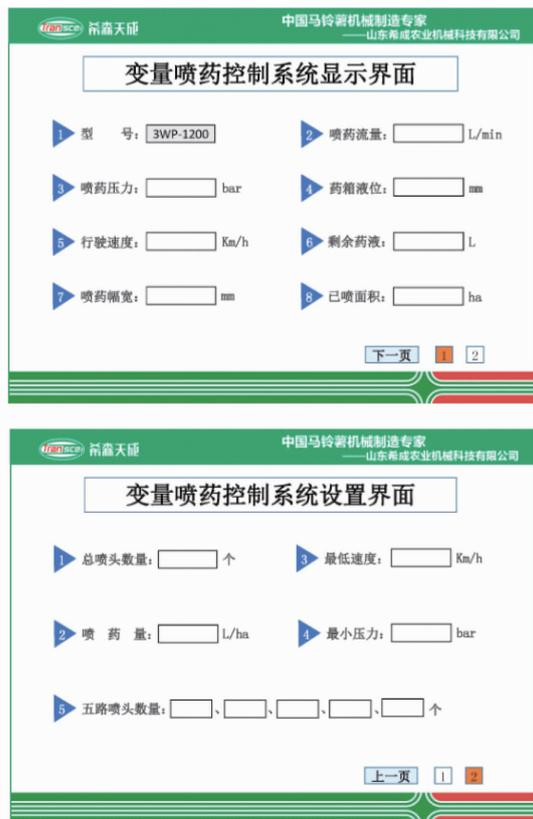
图 4 触摸屏显示和设置界面
