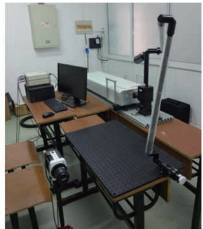
图2 试验用PIV系统实物图
