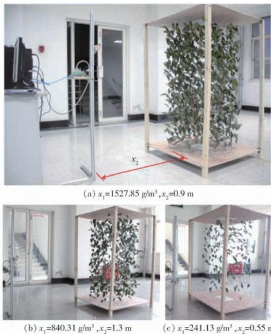
图 6 冠层密度量化测试现场图
