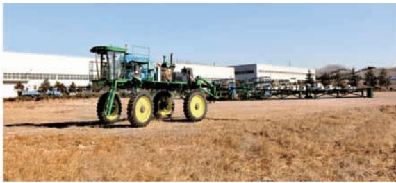
图13 转向系统田间试验
