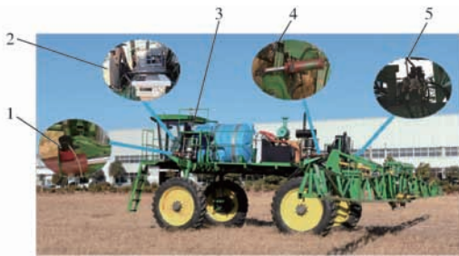
图12 多功能转向系统实车测试平台
