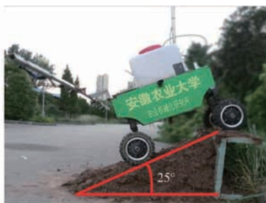
图 11 无人驾驶喷雾机爬坡试验
