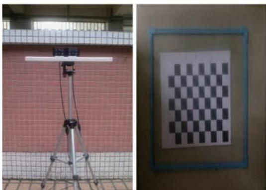
图2 双目相机标定试验平台
