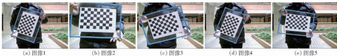
图 6 右相机采集到的 5 幅平面靶标图像
