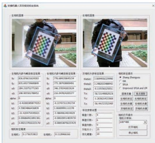
图3 采摘机器人双目视觉标定系统
