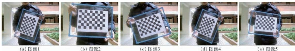
图 5 左相机采集到的 5 幅平面靶标图像
