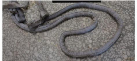
图11 装满砂土样芯的柔性软袋实物
