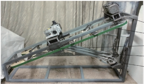
图 6 胡萝卜缨果拉拽式分离试验台
