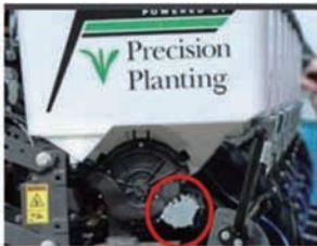
图4 电动机驱动排种器 Fig.4 Motor drives seed meter
