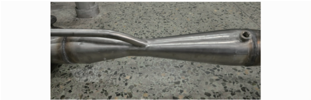
图 2 文丘里管实物图 Fig.2 Venturi physical map
