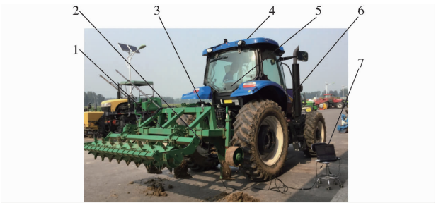
图 8 试验样机及系统
