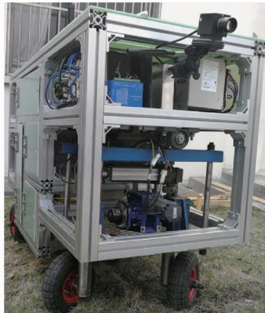
图 12 AGV 纯滚动转向系统及其草地路面转向试验
