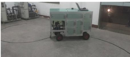
图 13 AGV 沿 S 型轨迹的转向行驶试验
