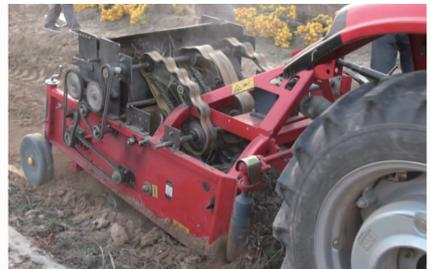
图9 联合回收机田间作业性能试验
