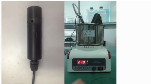
图5 浊度传感器与测试试验装置
