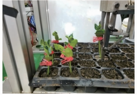
图 14 嫁接苗回栽作业测试
