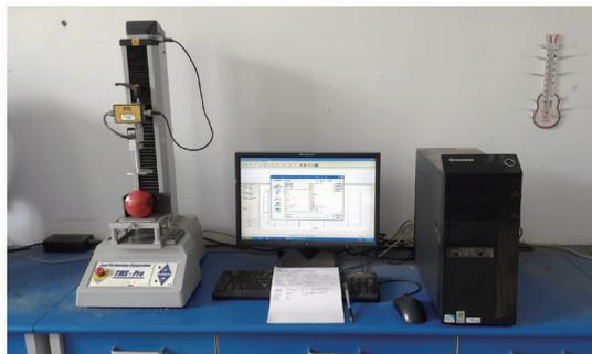
图 1 蠕变实验装置
