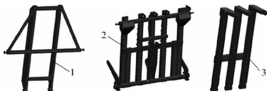
图6 卸草机构结构简图
