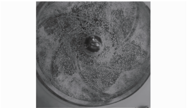
图 4 自吸过程叶轮的高速摄影图 Fig.4 High-speed image of the impeller
